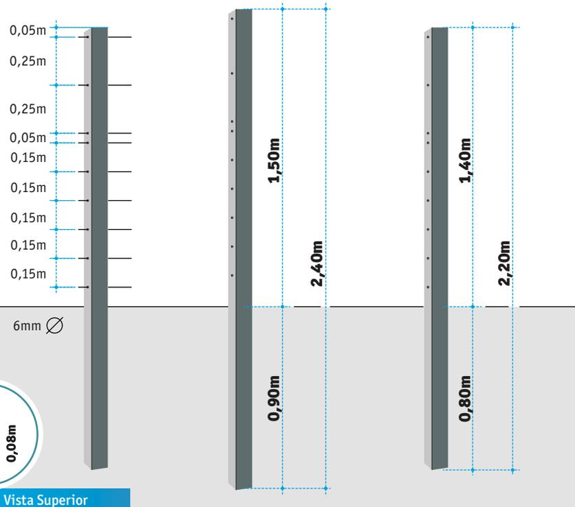
Los postes rurales TENSOLITE son elaborados en fábrica con hormigones pretensados y vibrados, que dan como resultado un producto de alta calidad y homogeneidad.
